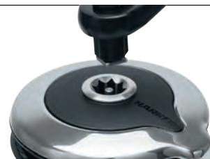
*L'insertion d'une manivelle à verrouillage Harken dans un winch hors charge déconnecte automatiquement la transmission du moteur pour permettre une utilisation manuelle.*
