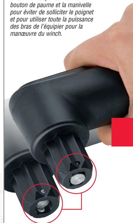
*Le mécanisme de verrouillage breveté comporte deux broches en acier inoxydable qui se rétractent automatiquement lorsque la manivelle est pressée et se déverrouille lorsque l'on la relâche pour une sécurité accrue.*
