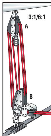
**Palan deux vitesses 3:1 / 6:1 :** Ce palan 2 vitesses 3 ou 6 brins est utilisé sur les bateaux avec écoute en bout de bôme pour une surface de grand voile jusqu'à 22,3 m<sup>2</sup> (240 ft<sup>2</sup>).
