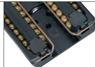
Les barrettes brevetées qui maintiennent les billes captives facilitent la mise en place et l'entretien des chariots. Les capuchons d'angle en matériau composite retiennent les billes lorsque les chariots sont extraits du rail. Les chariots CB peuvent également être modifiés et adaptés aux rails Harken non-CB.
