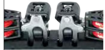
*Les cardans disposent d'un point d'articulation abaissé prévu pour encaisser les charges de grand-voile à un angle pouvant atteindre 40 degrés par rapport au plan vertical sans compromettre la circulation des chariots.*
