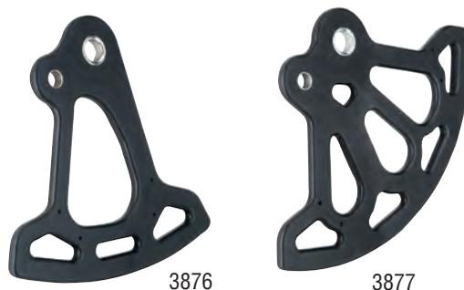
Plaques de têtes à sangle en aluminium facile à poser par les maîtres voiliers. Les bords des plaques sont arrondis pour protéger efficacement la voile. Les ouvertures permettent la pose de sangles de 25 mm (1"). Les trous pratiqués dans les plaques permettent la fixation de poulies à plaquer 416 pour le nerf de chute. Les plaques de tête à sangle sont nécessaires pour le chariot de tête CB 3867 Système C. Vendues séparément.
