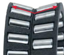
Les V Blocks tiennent leur nom de la disposition en V exclusive des rouleaux de leur roulement qui encaisse à la fois les charges radiales et axiales.
