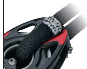
La fixation par transfilage s'effectue via le centre du réa et non de la tête. Le réa encaisse la charge principale, autorisant une réduction du poids et des dimensions de ces poulies.
