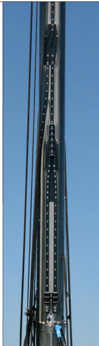
Le rail à aiguillage pour voile de cape intègre le système de chariots de latte à aiguillage sur le rail en T en place, contribuant ainsi à limiter le poids dans les hauts.
