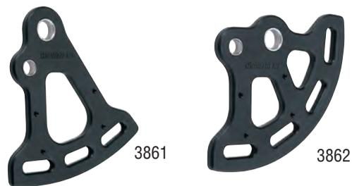
Les joues de tête aluminium web-on sont faciles à poser par les voiliers. Les joues ont les bords arrondis pour protéger la voile et se fixent sur les bandes de ralingue de 25 mm (1"). Les trous taraudés dans les joues permettent la pose de poulies à plaquer 416 pour le nerf de chute. Les joues Web-on sont impératives pour l'utilisation du chariot de tête CB Système B 3852. Vendues séparément.
