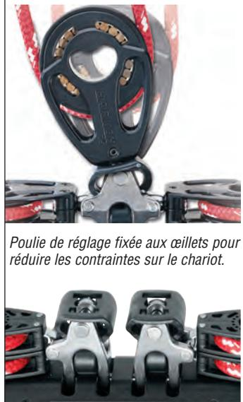
Poulie de réglage fixée aux œillets pour réduire les contraintes sur le chariot.
