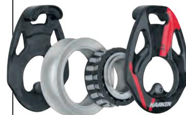
Conçues pour une maintenance simplifiée, ces poulies intègrent des rouleaux captifs et un nombre restreint de composants. Elles se démontent rapidement à l'aide d'une clé Allen.
