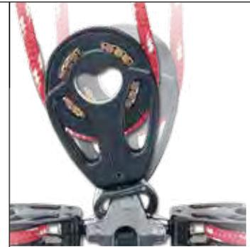
*Poulie de réglage fixée aux œillets pour réduire les contraintes sur le chariot.*
